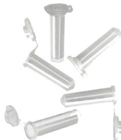
Graduierte Polypropylenröhrchen, geeignet für Belastungen durch Zentrifugation bei hohen Geschwindigkeiten (bis zu 20.000 x g)
